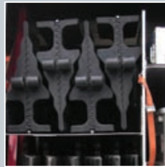
Die Crocodile nimmt nur ca. halb so viel Platz im Fahrzeug ein, wie herkömmliche Brücken
