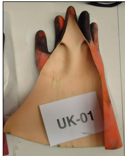
Isolier-Handschuh nach dem Auftreten eines Störlichtbogens (siehe Video)
