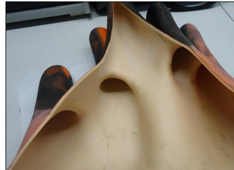
Isolier-Handschuh nach dem Auftreten eines Störlichtbogens (siehe Video)
