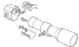
1. Verstellelement montieren
