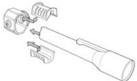
1. Verstellelement montieren
