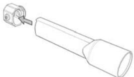
1. Verstellelement montieren
